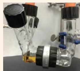
図：電解反応を利用する 遷移金属触媒反応装置の写真
