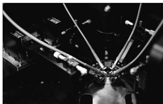
図2 スピントロニクスデバイス評価用の高周波プローバ装置
