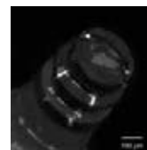
微小光共振器：円周上に設けられたリング内に光を閉じ込める
